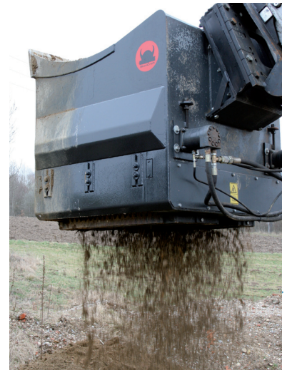
SB 14-21 als Baggeranbaugerät
