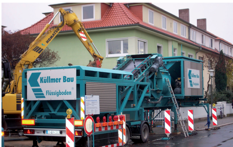
Mobile Anlage für die Herstellung von RSS Flüssigboden®
